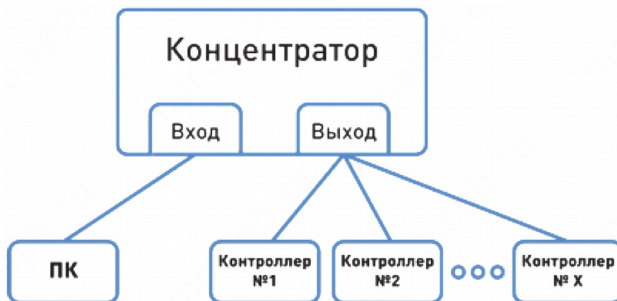
Рис. 37. Настройка подключения к ПК через концентратор
